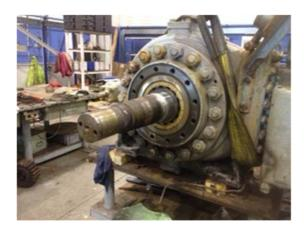
Smontaggio dei coperchi per ispezione rotore, si notano rigature sia sui coperchi che sul rotore, sarebbero necessarie lavorazioni che per le tempistiche della nave non sono possibili per cui si sostituiscono le guarnizioni e si richiude.
